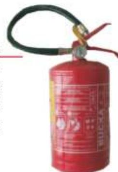
A válvula auto-selante permite uma série de jatos intermitentes, controlando assim o fluxo do agente extintor durante a aplicação. Para operar estes extintores é necessário retirar o pino de travamento, dirigir a mangueira de descarga à base do incêndio, apertar o gatilho (com o aparelho na posição vertical ou no máximo com 45 graus de inclinação) e "varrer" os focos de incêndio.
